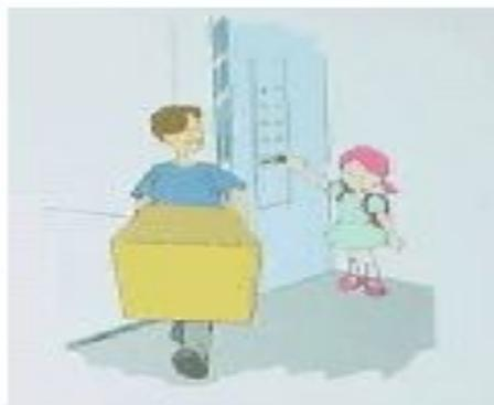
搬运大件时，若需保持层、轿门的开启应按下开门按钮，以免损坏层、轿门部件
